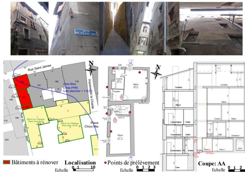
Fig. 1 : Vues en face des bâtiments démonstrateurs, localisation, plan étage intermédiaire et vue en coupe.
