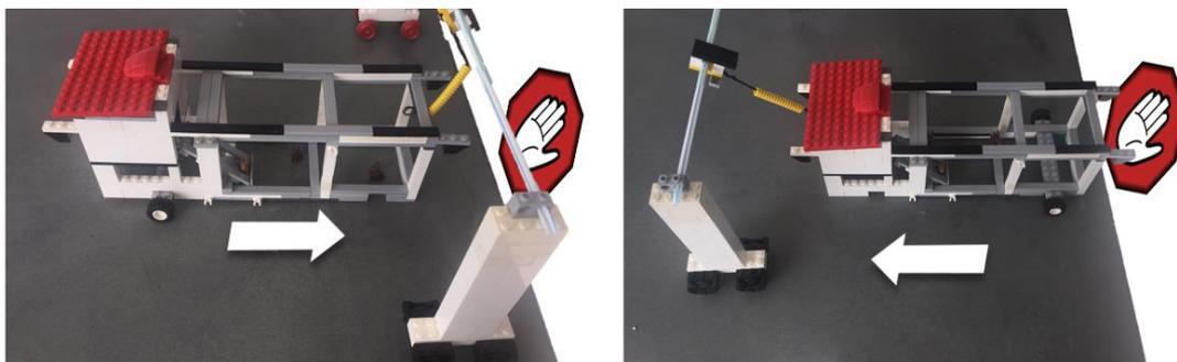
Figure 39 : Gestion de la fin de champ avec l'enrouleur, aide au déplacement des cages mobiles en cuniculture AB
